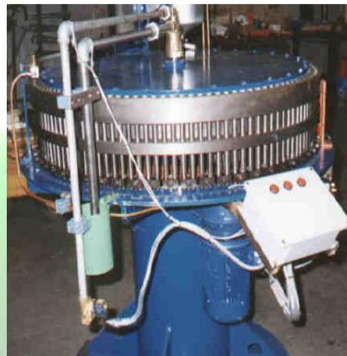
Расплавленный свинец подается с помощью центробежного насоса из печи плавления свинца по трубопроводам с предварительным нагревом в головку машины отливки цилиндров.
