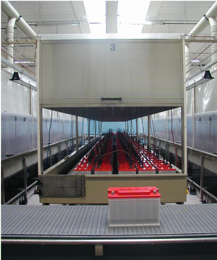
Емкости воды проектируются в зависимости от потребности клиента, зависимо от количества зарядных устройств, места, количества производимых батарей, типа батарей, но наиболее важным является количество смен и людей, которые работают на каждой емкости.
