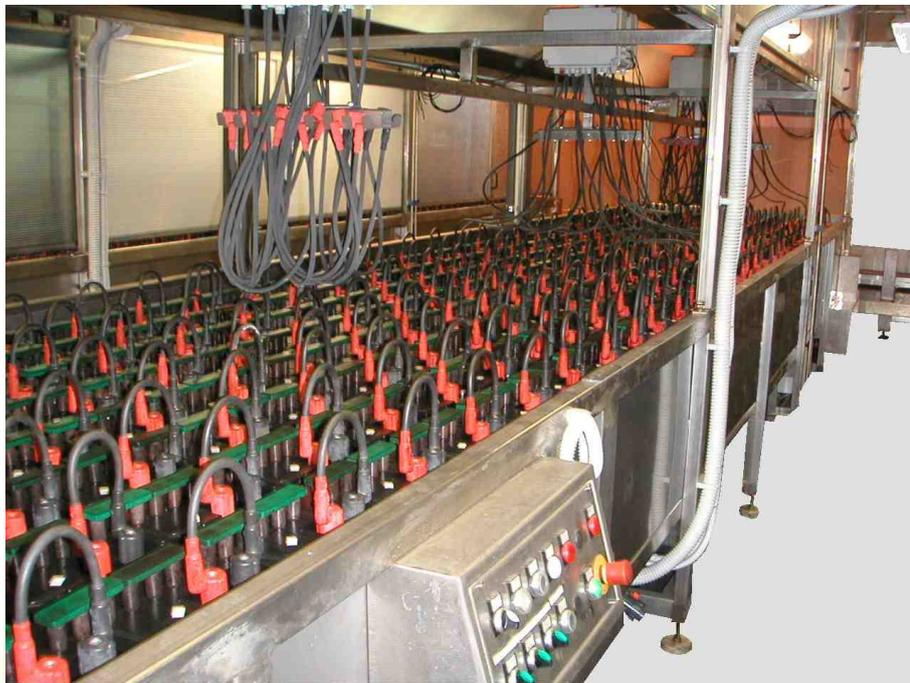
Эти контейнеры являются оптимальным вариантом для зарядки батарей. Эти емкости для воды изготовлены из пластика, они являются полностью автоматическими на входе батарей и на их выходе на финишную линию, с открытием и закрытием дверей и при заполнении/отборе воды.
